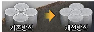
DCM공법은 1985년 국내 최초 도입된 이후 항만공사에 매우 많은 공사실적을 보유하고 있으며, 시공장비 개선으로 개량면적이 확대되어 경제적인 시공이 가능하게 되었다. 그러나 토출구 위치는 개선되지 않아 단면이 커질수록 균질한 품질확보가 어렵게 되었다. 따라서 본 연구는 DCM장비의 토출구 위치 변경 및 중앙 소형 날개를 추가하는 장비개선을 통하여 고화재를 균일하게 주입시키고 미개량 구간을 추가 교반 함으로써 고품질의 개량체가 형성할 수 있는 장비개선 방안을 제안하였다.
